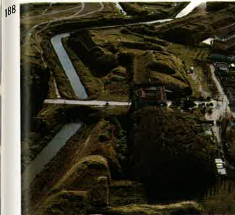
188. Palmanova, il settore di cortina ove è collocata porta Cividale; la ripresa aerea consente di cogliere le varie componenti del complesso sistema urbano concepito dai tecnici della Serenissima; a destra sono visibili, dopo il pomeriggio, due caserme veneziane e una polveriera (napoleonica), mentre sulla sinistra, dopo le cortine e i baluardi, si vede il fossato, in parte calibrato e percorso dall'acqua.
